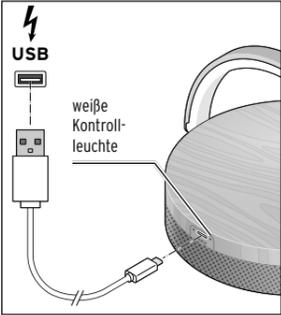
2. Schließen Sie das eine Ende des USB-C-Ladekabels an die Anschlussbuchse am Lautsprecher und das andere Ende an den USB-Netzadapter an.
