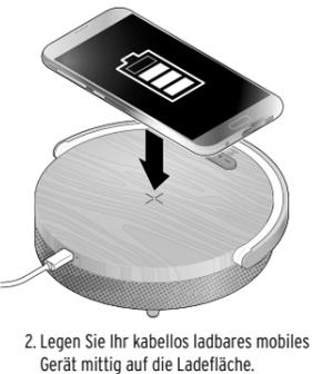
Der Ladevorgang startet automatisch. Die weiße Kontrollleuchte erlischt und die blaue Kontrollleuchte leuchtet, während das Gerät lädt. Die Ladedauer ist abhängig von der Akku-Kapazität des Gerätes, das Sie laden.
